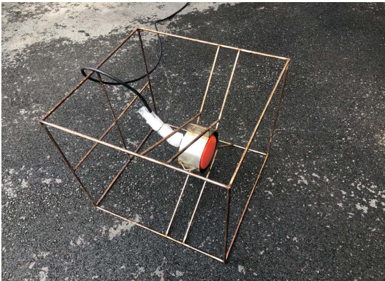
图 4 换能器水平固定装置 Fig. 4 Transducer horizontal fixture device
