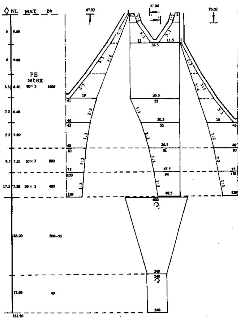
图1 240m近底层拖网网图
